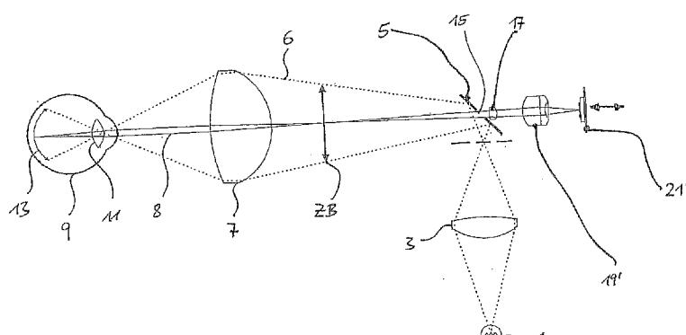
(57) Zusammenfassung: Eine Vorrichtung zum Betrachten eines Augenhintergrundes, insbesondere eine Funduskamera, enthält eine Lichtquelle (1b) zum Bereitstellen von Beleuchtungsstrahlung; einen Beleuchtungsstrahlengang zum Richten der Beleuchtungsstrahlung auf den Augenhintergrund; und eine Beobachtungsoptik zum Abbilden des beleuchteten Augenhintergrundes, wobei die Beobachtungsoptik eine hinsichtlich ihrer Brechkraft elektrisch einstellbare Baugruppe (16b) umfasst.
