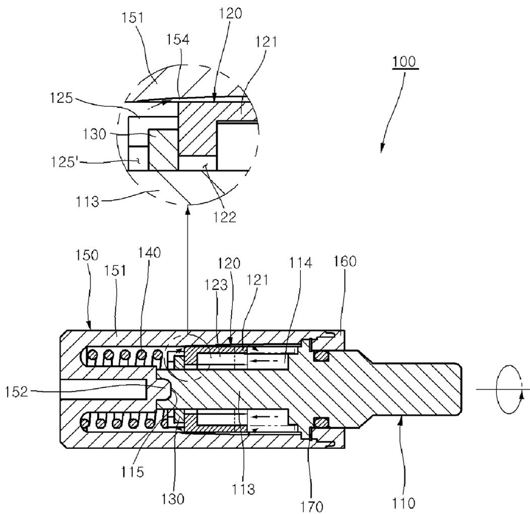
**OIL DAMPER USING A CAM**
