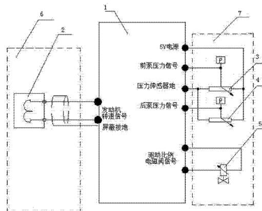
1. 一种中大型液压挖掘机负流量液压泵的功率控制系统,其特征在于,包括电气控制器(1)、发动机转速传感器(2)、前泵压力传感器(3)、后泵压力传感器(4)、比例电磁阀(5);所述发动机转速传感器(2)与电气控制器(1)相连,输入发动机转速信号;所述前泵压力传感器(3)、后泵压力传感器(4)分别与电气控制器(1)相连,输入前泵压力信号、后泵压力信号;所述电气控制器(1)与比例电磁阀(5)相连,输出比例电磁阀驱动信号。
