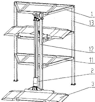
1. 一种旋转升降式立体车库，包括停车架、搬运器和载车板；
