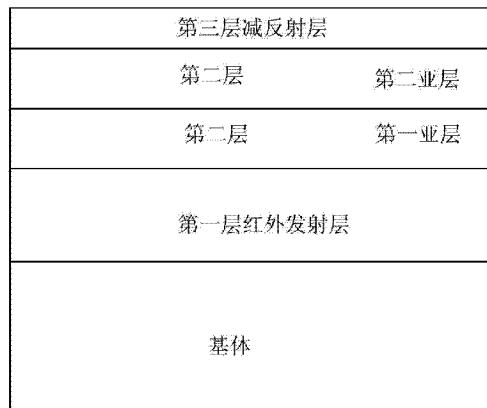
1. 一种具有  $\text{Si}_3\text{N}_4$  和  $\text{AlN}$  双陶瓷结构高温太阳能选择性吸收涂层，其特征在于：所述的涂层从底层到表面依次为红外发射层、吸收层和减反射层；
