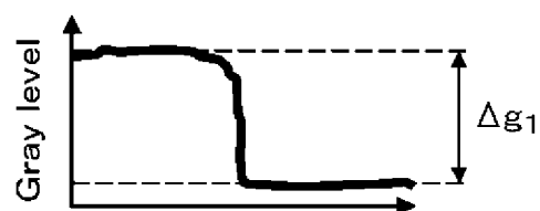
(b) エネルギーフィルタリングが適切に行われたときに得られるプロファイル波形
