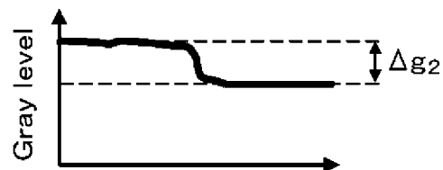
(c) エネルギーフィルタリングが適切に行われなかったときに得られるプロファイル波形
