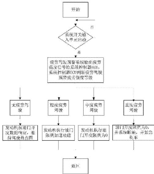
1. 一种汽车疲劳驾驶安全防护系统,其特征在于:包括疲劳驾驶预警系统(1)、系统开关输入单元(2)、油门开度信号单元(3)、发动机转速信号单元(4)、车速信号单元(5)、系统控制器(6)、发动机控制器(7)、油泵继电器单元(10)和电子稳定控制系统(11);
