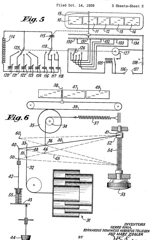
RADIO RECEIVER WITH BAND SPREADING
