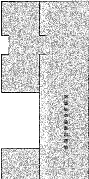
Fig. 3B. Piezoresistor Implant: 5E16 cm -2 , 150 keV, B11.
