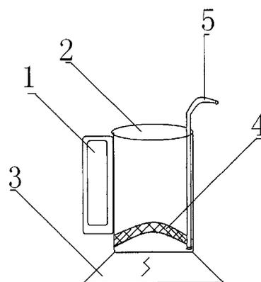
1. 中药煎药器,包括手柄(1)和药缸(2),其特征是:在药缸(2)底部设有加热器(3),药缸(2)内设有滤网隔离罩(4),滤网隔离罩(4)内设有吸管(5)。
