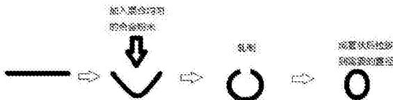
1. 一种 Q420 钢焊接用药芯焊丝, 其特征在于, 由外皮和填充在所述外皮内的药芯构成; 所述外皮为低合金高强度钢带, 所述药芯的成分按质量百分含量计为:
