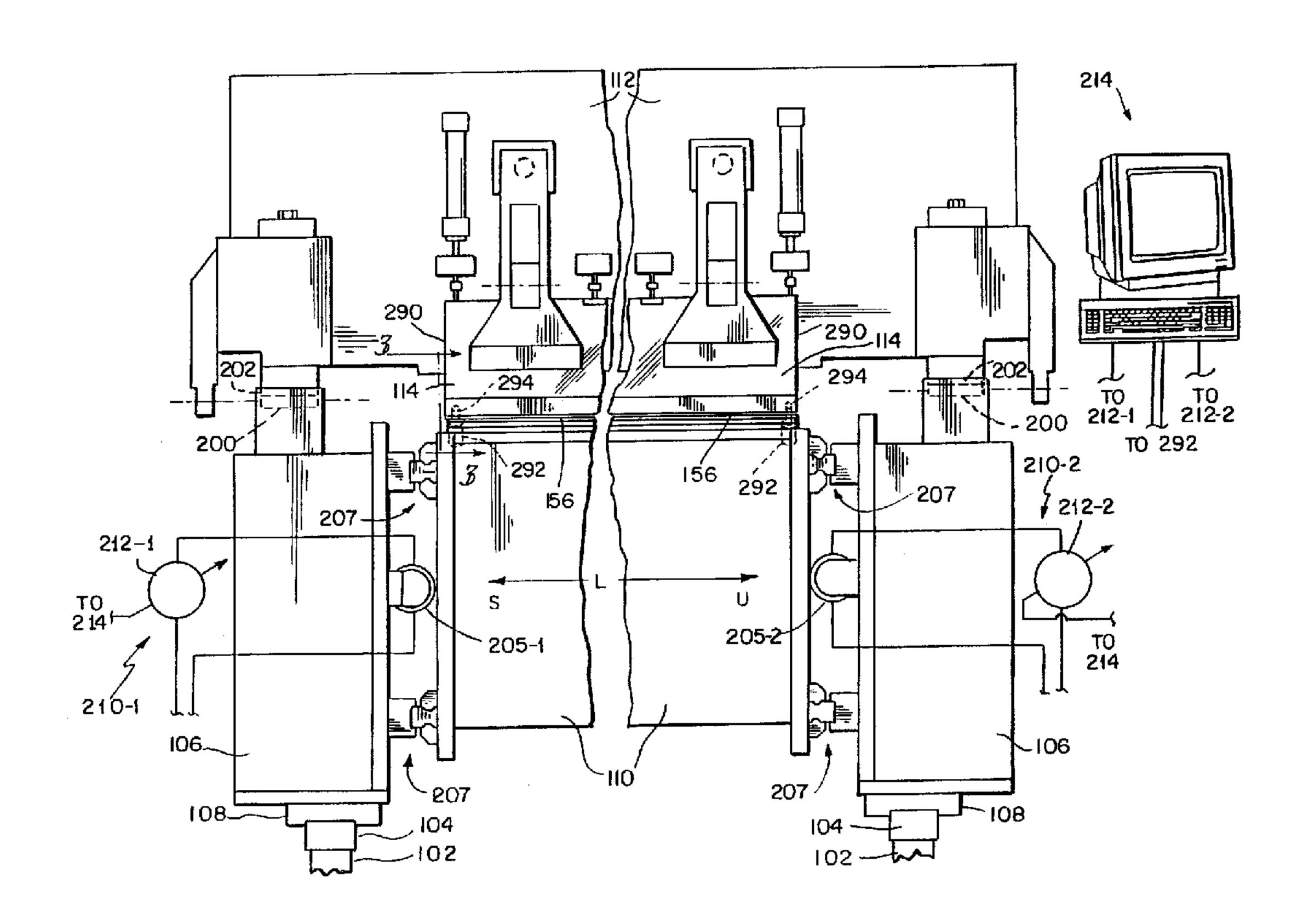
(57) Cette machine à découper des feuilles de placage (100) comprend un dispositif pour imprimer un mouvement de va-et-vient à une bille de bois (120) dans laquelle les feuilles de placage doivent être découpées, un dispositif (112) de support d'une lame (114) servant à découper des feuilles de placage dans la bille (120) pressure bar (156) for contacting the flitch (120) and
