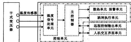
1. 一种干式变压器温度控制仪，其特征在于包括温度检测单元和控制单元，所述控制单元包括依次相连的温度信号处理单元、主控制器以及可对干式变压器进行散热的散热单元，所述温度检测单元与控制单元中的温度信号处理单元的输入端相连，温度信号处理单元对温度检测单元采集到的温度数据进行信号处理后，将该信号送入主控制器，由主控制器判断是否启动散热单元对干式变压器进行散热。
