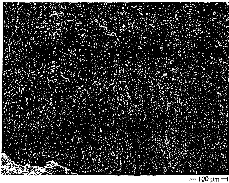
圖 13B :在 200 倍放大倍率下 Nal-Extr 顆粒之表面。電壓為 10 kV， 橫條長度相當於 100 \mu m。
