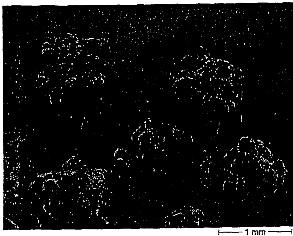
圖 12A :在 30 倍放大倍率下 Nal-10-Sure 顆粒之表面。電壓為 10 kV , 橫條長度相當於 1 公釐。
