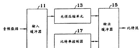
1、一种解码经编码的音频数据的无损解码器，该经编码的音频数据已经按如下顺序被无损压缩编码，其中所述编码的音频数据的一些原始数据单元具有超过最大比特率的数据量，该超过数据量已经被与具有小于最大比特率的数据量的其它原始数据单元相结合，该解码器包括：
