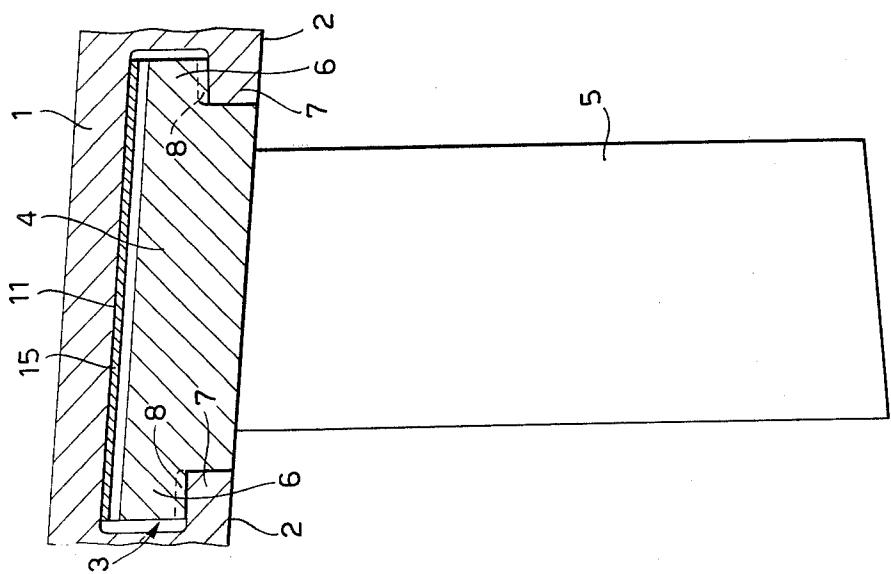
**SYSTEM FOR LOCKING THE BLADES IN POSITION ON THE STATOR CASE OF AN AXIAL COMPRESSOR**
