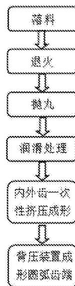
1. 一种车用花键套零件的冷挤压成形方法,所述花键套呈轴对称的圆筒状,筒体的内、外表面上均开设有轴向的渐开线花键齿,外花键齿的端面呈现圆弧状,其特征在于,该方法包括以下步骤:
