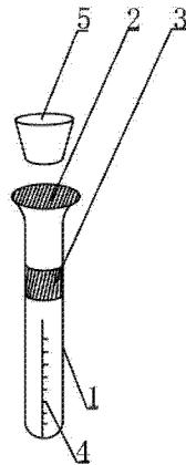
1. 一种新型试管，其特征在于：包括管体，所述管体口为喇叭形，所述管体口内壁设有磨砂纹，所述管体上部外壁一侧设有磨砂纹，所述管体中部设有橡胶圈，所述管体下部设有刻度，所述管体的瓶口设有瓶塞。
