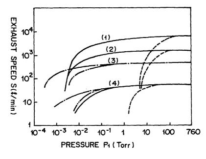
(1) ROTARY PLUNGER TYPE (7.5kw)
