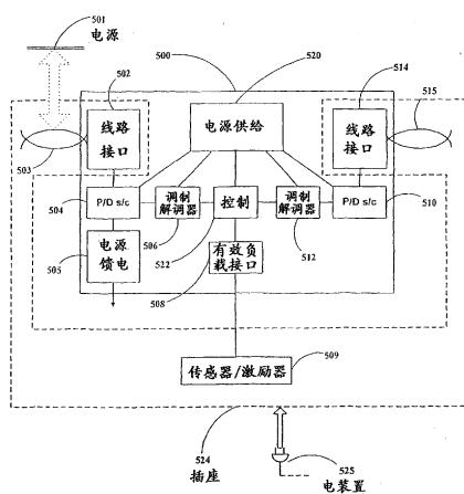
1、一种用于将数据终端设备单元耦合到由建筑物中的布线承载的数据信号的设备，所述建筑物中的布线在承载所述数据信号的同时承载电源信号，所述设备包括：
