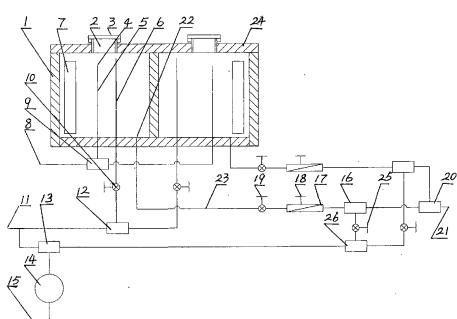
1、一种水质处理装置，由水处理容器（1）、进水系统、加药口（2）、排放系统、溢流系统和动力系统组成，容器（1）顶端开有加药口（2），容器（1）内接入进水管（6），该进水管（6）引出容器（1）外部分管道接入加水阀（10），容器（1）底部开有出水口（22）并通过出水管（23）连接流量阀（18）、流量计（17）、加药阀（19），在容器（1）内还装有溢流管（5）和水位器（7），其特征在于：由两个水处理容器（1）组成，两个容器（1）的进水系统通过三通（12）连通；两个容器（1）的溢流系统通过三通（9）连通；两个容器（1）的排药系统通过三通（20）连通。
