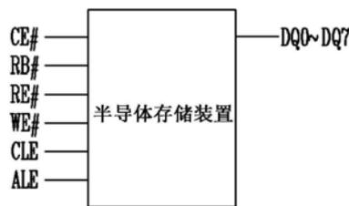
1. 一种半导体存储装置,该半导体存储装置包括:
