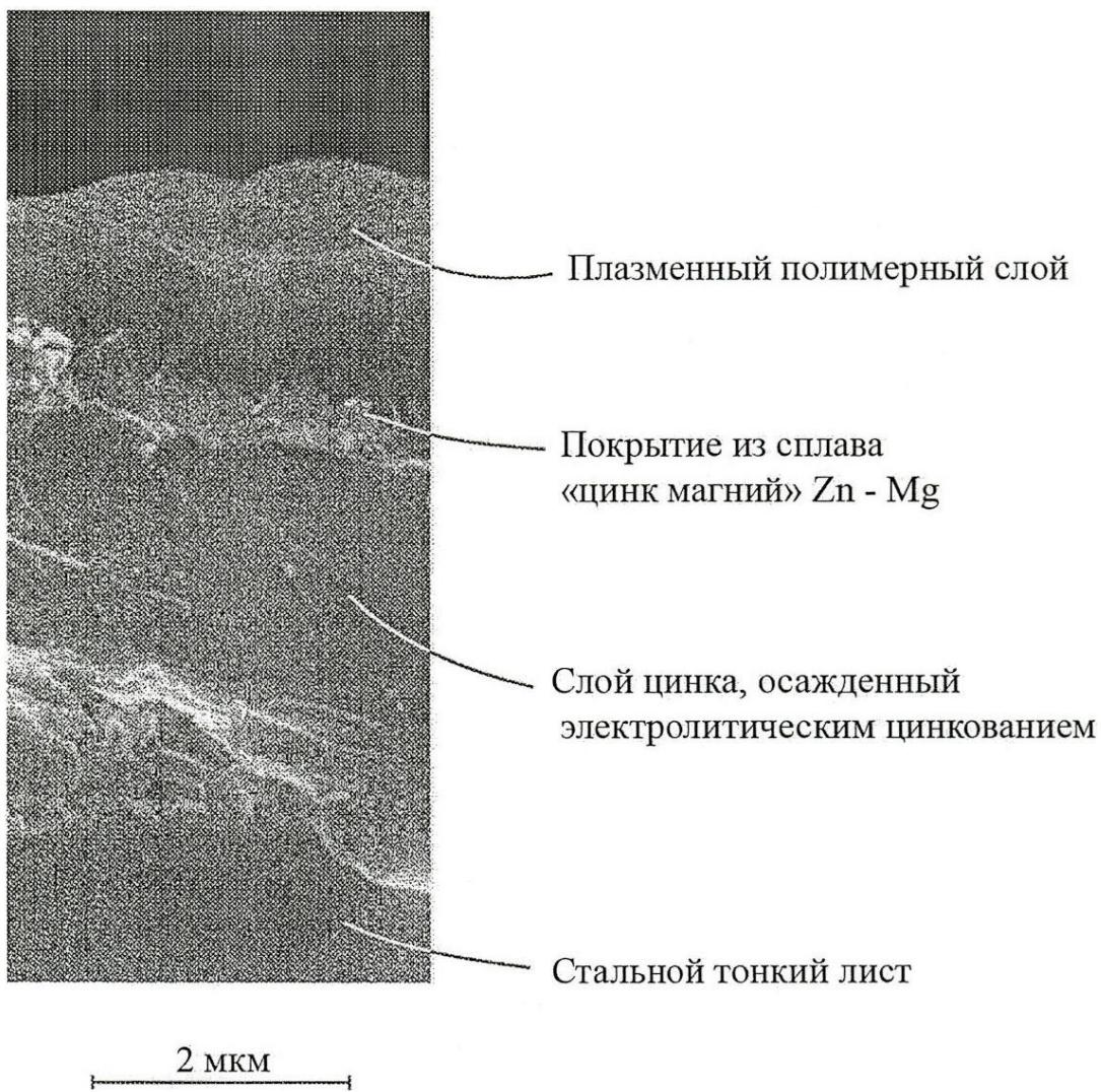
Изображение многослойной системы защиты от коррозии, согласно изобретению, на основе цинка Zn, осажденного электролитическим цинкованием (ZE) - покрытия из сплава «цинка - магний» (ZnMg) - плазменного полимерного слоя.
