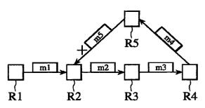
m1=(INGRESS=R1,FLOWID=DEST,LABEL=a) m2=(INGRESS=R1.FLOWID=DEST.LABEL=b) m3=(INGRESS=R1,FLOWID=DEST,LABEL=c) m4=(INGRESS=R1,FLOWID=DEST,LABEL=d) m5=(INGRESS=R1,FLOWID=DEST,LABEL=e)
