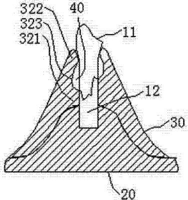
1. 一种齿科模型用牙龈套件,包括模型牙(10)、模型牙龈(30)和模型牙列(20),以使用方向为基准,模型牙列(20)上侧设有插入穴(21),模型牙龈(30)能够拆卸固设于模型牙列(20)上方,模型牙龈(30)下侧面与模型牙列(20)上侧面紧密贴合,模型牙龈(30)上设有与模型牙列(20)上插入穴(21)相通的插入通孔(31),模型牙(10)上部为牙冠部(11),下部为牙根部(12),模型牙(10)的牙根部(12)能够拆卸固定插置于模型牙龈(30)的插入通孔(31)和模型牙列(20)的插入穴(21)内,模型牙(10)的牙冠部(11)止挡于模型牙龈(30)上端外侧面,其特征在于:所述模型牙龈(30)为弹性材料制成,模型牙龈(30)的插入通孔(31)内侧壁与模型牙(10)的牙根部(12)外侧壁之间形成有一圈密封环状空隙(40)。
