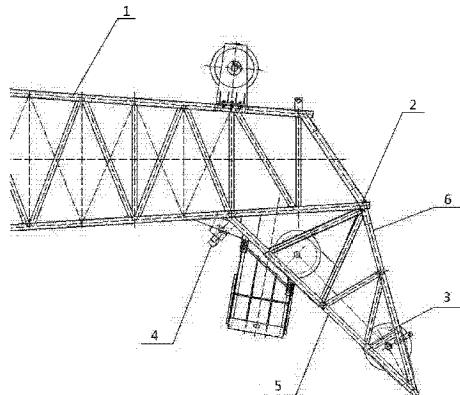
1. 一种动臂塔式起重机起升三倍率绕绳鹰嘴形臂头，它包括起重臂(1)，其特征在于：所述起重臂(1)端部设有尖端部斜向下的鹰嘴形臂头(2)，鹰嘴形臂头(2)下层平面(5)靠近下端部的中间处设有导向滑轮(3)，鹰嘴形臂头(2)靠近上端部处设有臂端理直器(4)，鹰嘴形臂头(2)上端部与起重臂(1)连接。
