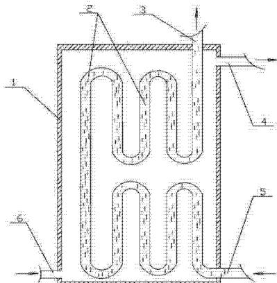
1. 一种锅炉余热回收装置,包括保温筒体(1)、盘管(2),其特征在于:保温筒体(1)内设置盘管(2),盘管(2)的进水口(5)、出水口(3)分别设在保温筒体(1)底部侧面和顶部,保温筒体(1)还开有进气口(6)和出气口(4)。
