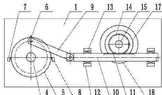
1. 一种间歇性撒种机构，其特征在于：它包括机架、摆动气缸、气缸支座、驱动轴、圆盘、触发块、左行程开关、右行程开关、连杆、滑动轴、齿条、轴支座、滚珠滑套、齿轮、支承轴、支承支座、内滚筒、外套筒，所述圆盘可转动设置在机架上，所述摆动气缸通过驱动轴和圆盘同轴连接，所述摆动气缸安装在气缸支座上，所述连杆的一端铰接在圆盘上，所述连杆的另一端铰接在滑动轴的左端，所述滑动轴可左右滑动设置在轴支座上，所述滑动轴和轴支座之间设置有滚珠滑套，所述齿条安装在滑动轴的上侧，所述支承轴可转动设置在支承支座上，所述齿轮同轴心设置在支承轴的一侧，所述齿轮和齿条相互啮合，所述内滚筒同轴心安装在支承轴上，所述外套筒固定在机架上，并且和内滚筒同轴心设置，所述内滚筒和外套筒上设置有交错的撒种槽，所述触发块设置在圆盘外侧，所述左行程开关和右行程开关设置在机架上，位于圆盘的两侧。
