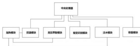
1. 一种自动化咖啡冲煮系统,其特征在于,包括中央处理器,以及与所述中央处理器相连接的视觉识别模块、称重模块、控温模块、加热模块、注水模块和高压萃取模块,其中:
