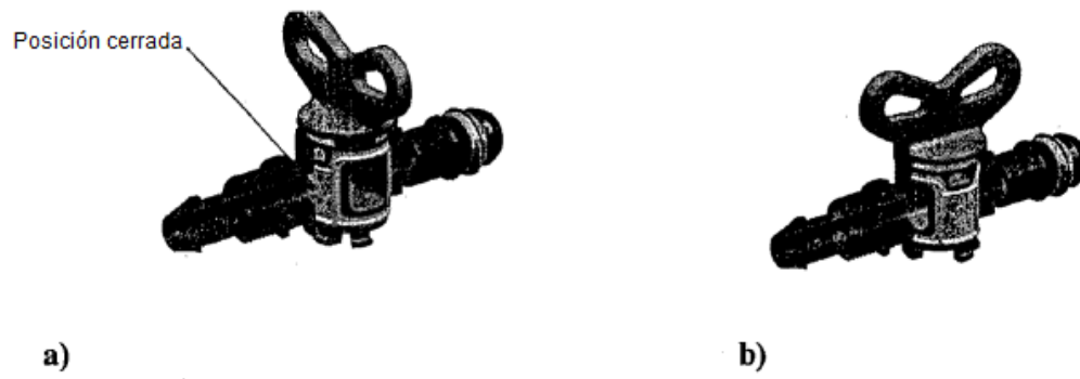
Figura 3 Núcleo de válvula nuevo (1): a) Posición cerrada (b) Posición abierta
