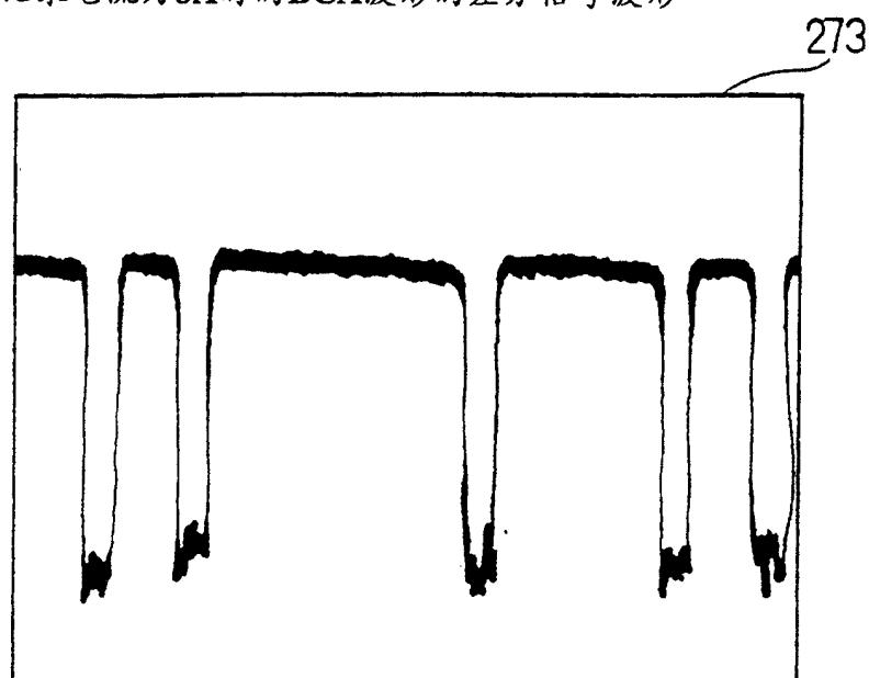
(b) 记录电流为8A时的BCA信号的相加信号波形
