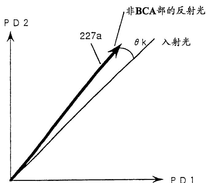
(b) BCA部的反射光偏振面的旋转角
