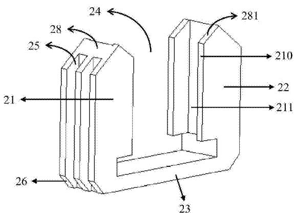
1. 一种定位块，所述定位块具有由左隔垫部、右隔垫部和底部共同围成的定位槽；所述左隔垫部和/或右隔垫部的外侧面上设有基本垂直于底部上表面的导流槽。
