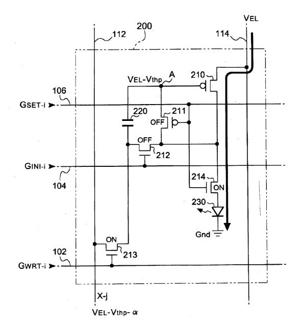
COMPLETION OF OFF VOLTAGE DETERMINATION
