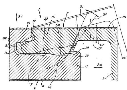
1. 一种屋面盖板，它包括硬板条（2），由此至少在两个相对边缘（3，4，5，6）上板条（2）带有与板条（2）形成为整体的联接装置（7），从而多个板条（2）可相互组装，由此联接装置（7）在垂直于屋面盖板（1）的平面的方向（R1）上起互锁作用，同时在垂直于所涉及的边缘（3，4，5，6），并平行于屋面盖板（1）的平面的方向（R2）上起互锁作用，联接装置（7）使板条（2）的底侧一方面从扁平位置开始，彼此相向旋转超过至少一个角度，另一方面该旋转运动使两个板条（2）从相邻板条（2）之间拆卸下来；其特征在于联接装置（7）主要包括突舌（8）和凹槽（9），由此位于凹槽（9）底侧上的凸缘（11）长于位于顶侧上的凸缘（10），并且由于位于凹槽（9）底侧的凸缘（11）上的互锁部分（13），和与其相邻的，位于其它板条（2）底侧的互锁部分（47），主要在水平方向获得互锁，由此这些联接装置（7）通过旋转运动组装板条（2），并且在组装位置上，在上述第一互锁部分（13）之上，和在可进一步旋转的上述第二互锁部分（47）之下存在有间隔（48，49）。
