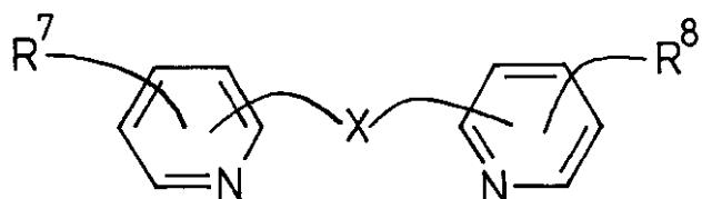
(式(2)中、R<sup>7</sup>～R<sup>8</sup>はそれぞれ独立で、ハロゲン原子、炭素数1～3のアルキル基、フェニル基または水酸基であり、結合手Xは、共有結合、炭素数1～3のアルキレン基またはイミノ基)で表される2個のピリジン環を有する化合物からなる非水電解質二次電池用電解液。
