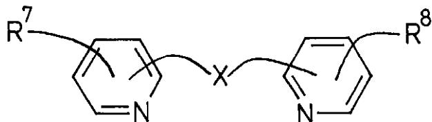
(式(2)中、R<sup>7</sup>～R<sup>8</sup>はそれぞれ独立で、ハロゲン原子、炭素数1～3のアルキル基、フェニル基または水酸基であり、結合手Xは、共有結合、炭素数1～3のアルキレン基またはイミノ基)で表される2個のピリジン環を有する化合物からなる非水電解質二次電池。
