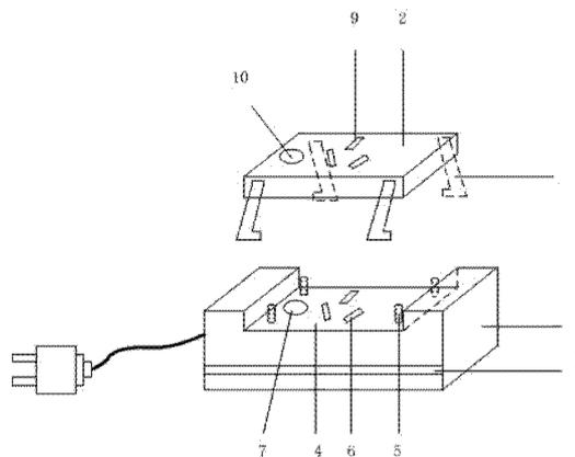
1. 一种方便插头拔出的插线板,包括底座(1)和运动盖(2),其特征在于:底座(1)上有凹槽(4)、卡扣槽(3)、弹簧(5)、第一电源插孔(6)和电源开关(7),运动盖(2)上有卡扣(8)、第二电源插孔(9)和电源孔(10),其中,凹槽(4)位于底座(1)的上表面,与运动盖(2)尺寸一致,凹槽(4)上固定有四个弹簧(5),弹簧(5)的另一端固定在运动盖(2)上;第一电源插孔(6)位于凹槽(4)上,第二电源插孔(9)位于运动盖(2)上,第一电源插孔(6)与第二电源插孔(9)形状、尺寸完全相同;卡扣槽(3)位于凹槽(4)的前后两个侧面上,卡扣(8)固定于运动盖(2)的前后两个侧面上;当底座(1)和运动盖(2)闭合时,卡扣(8)可以卡入卡扣槽(3)内,第一电源插孔(6)与第二电源插孔(9)正对;电源开关(7)位于凹槽(4)上,电源孔(10)位于运动盖(2)上与电源开关(7)相对应的位置上,电源开关(7)通过电源孔(10)露出。
