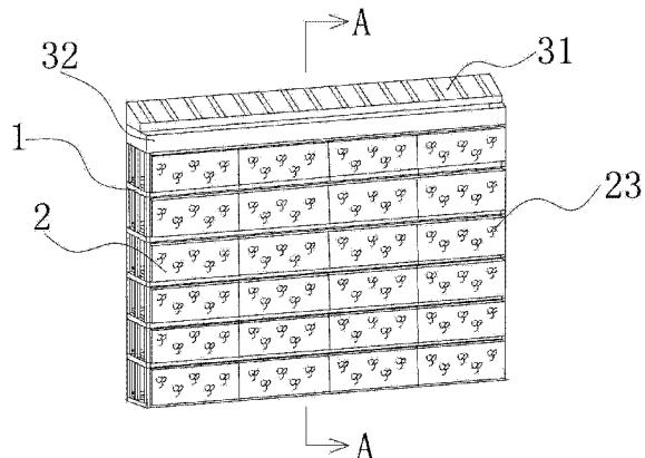
1. 一种室外生态绿化墙,包括固定框架、植物模块和给水系统,其特征在于:所述固定框架沿垂直方向上设置有若干水平支架,在每一水平支架上设置有水平隔板,所述的植物模块安装于水平隔板上,所述植物模块包括敞口种植框、填充于该种植框内的种植基质以及种植于该基质中的植物,所述种植框的敞口以塑料网覆盖,种植框外以绳状物包扎;所述的给水系统包括设置于固定框架顶部的向下倾斜的斜顶、位于该斜顶下方的集水槽以及开 口于该集水槽的若干根给水管道,所述给水管道沿整个长度方向开有若干开口,给水管道穿插于所述种植框内。
