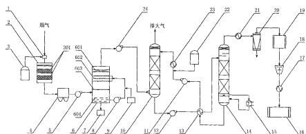
1. 一种燃煤烟气多污染物脱除工艺，是针对燃煤烟气中的二氧化硫、氮氧化物、粉尘和二氧化碳进行集成脱除处理的过程，其特征在于：该工艺包括如下步骤：
