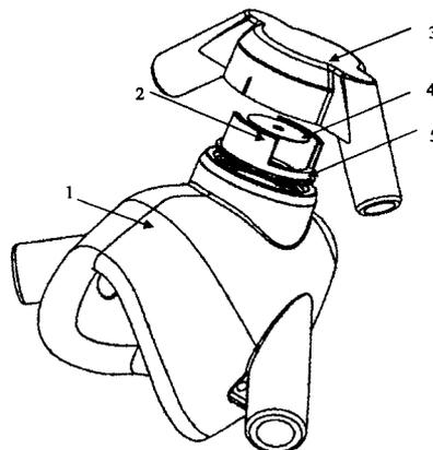
1. 一种医用鼻罩，包括具有吸气口和呼气口的鼻罩本体，所述呼气口处设置有单向阀瓣，其特征在于，还包括具有排气口的鼻罩上罩以及用于支撑所述鼻罩上罩的上罩支架，所述鼻罩上罩封闭住所述呼气口，所述鼻罩上罩内壁上设置有圆弧形卡槽，所述上罩支架包括安装在所述呼气口的环形基座和自所述环形基座向上延伸的圆弧形卡销，所述圆弧形卡销适配地插入所述圆弧形卡槽，所述呼气口的周缘配置成环形壁，所述鼻罩上罩包括环形的主体和连通所述主体的排气管，所述主体密封地套住所述环形壁，所述鼻罩本体由柔软、高弹性的硅胶制成，所述鼻罩上罩由聚碳酸酯材料制成。
