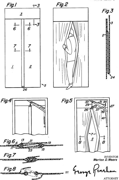
IMPERMEABLE SLIT-TYPE FLEXIBLE DOOR
