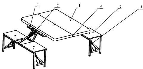
1、便携式四人折叠桌椅，它是由提手锁扣（1）、桌凳连接架（2）、桌面板（3）、铰链（4）、凳子（5）、凳支架（6）连接而成，其特征是：带有提手的桌面板（3）由提手锁扣（1）连接；桌面板（3）与凳子（5）由桌凳连接架（2）连接，桌凳连接架（2）一端固定在桌面板（3）的中间底面上，其另一端固定在凳子（5）的中间横撑上。
