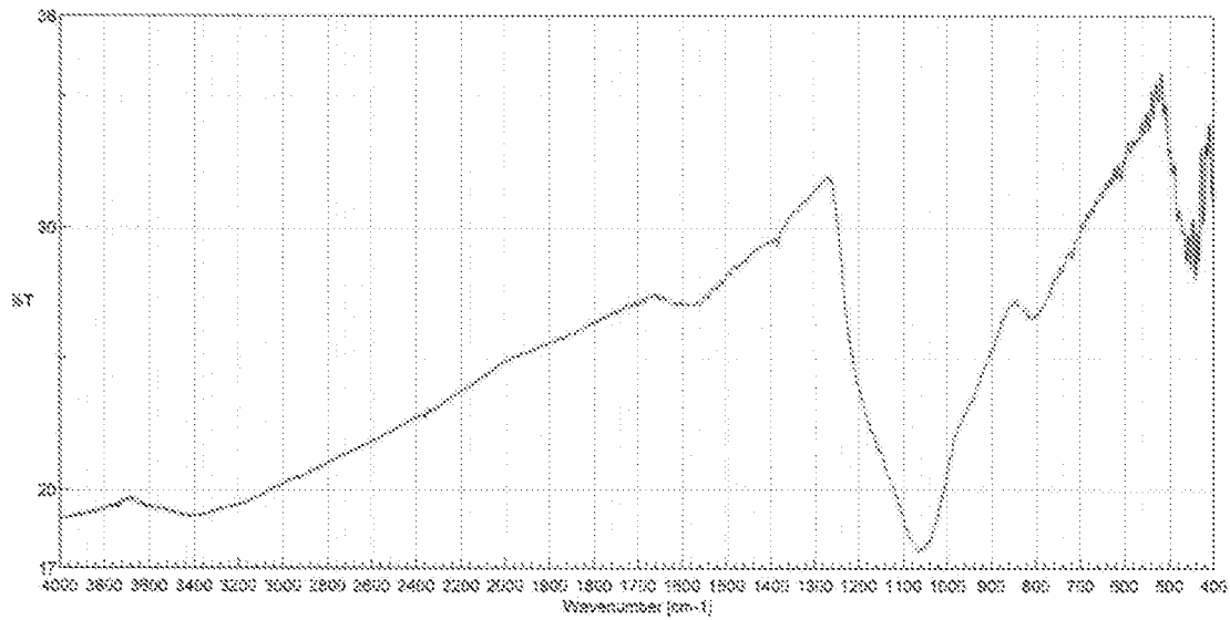
図1 実施例1で得られた二次電池用材料のF T-I Rスペクトル
