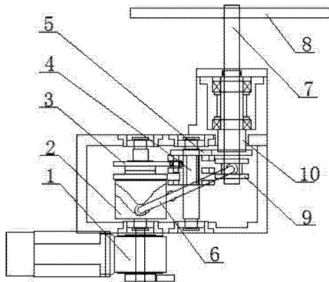
1. 一种龙门式加工中心刀库 ATC 换刀装置,包括电机(1)、圆柱凸轮(2)、驱动凸轮(3)、从动凸轮(4)、齿轮(5)、摇臂杆(6)、花键轴(7)和刀臂(8),其特征是,圆柱凸轮(2)和驱动凸轮(3)叠层套在电机(1)主轴上,从动凸轮(4)和齿轮(5)套在同一根转轴上,花键轴(7)的顶端和底端分别连接刀臂(8)和联接环(9),中部设有轴套(10),驱动凸轮(3)通过从动凸轮(4)与花键轴(7)连接,圆柱凸轮(2)通过摇臂杆(6)与花键轴(7)连接。
