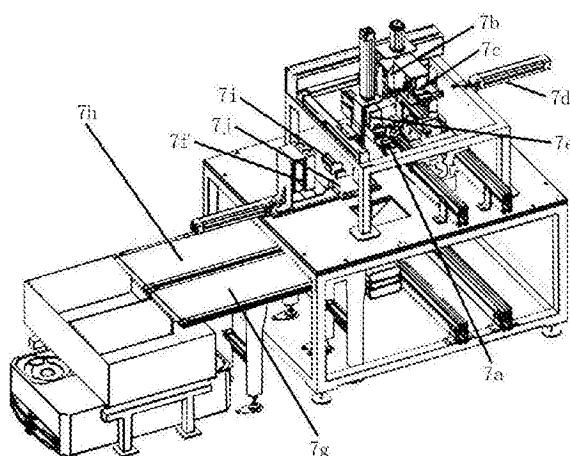
1. 一种废旧电能表自动拆上表盖系统,其特征在于,包括后盖掀起机构、上表盖提取机构、冲压拆钉机构以及上表盖中转机构;
