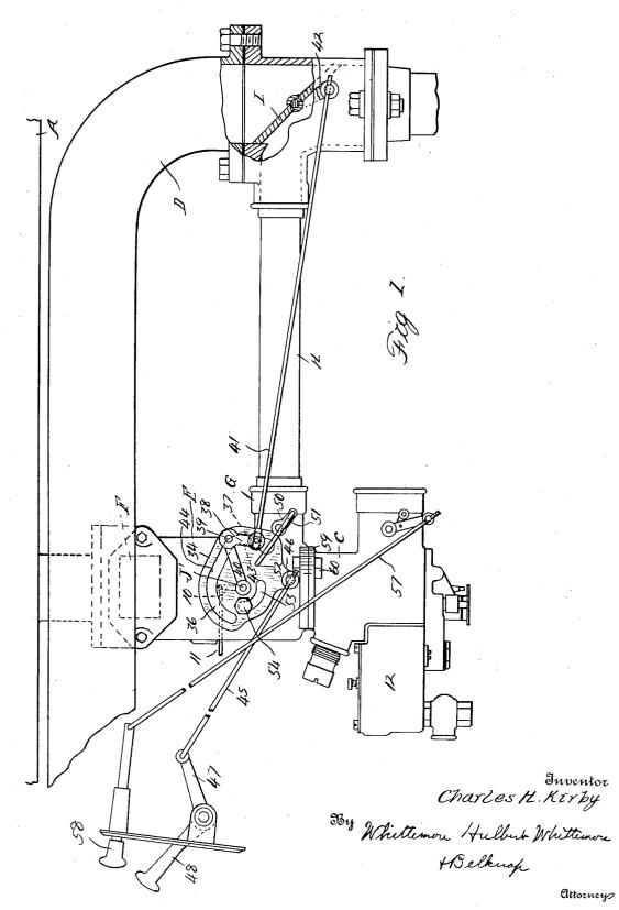
COOPERATING HEAT AND FUEL REGULATION FOR INTAKE MANIFOLDS
