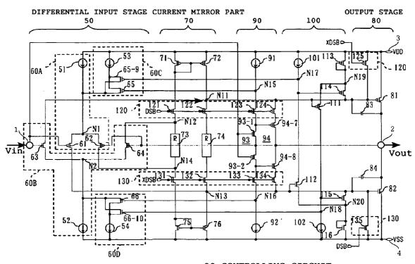
90:CONTROLLING CIRCUIT 100:OUTPUT AUXILIARY CIRCUIT
