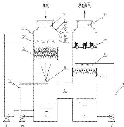
1. 一种双循环烟气除尘脱硫塔，其特征在于，所述脱硫塔包括预处理单元和深度处理单元，二者构成“H”型或“U”形双塔结构，其中所述的预处理单元自上而下包括烟气入口、一级喷淋系统、水滴形规整填料组件、湍冲洗涤器和一级持液槽，所述的深度处理单元自下而上包括二级持液槽、填料组件、除雾器和净化烟气出口，预处理单元和深度处理单元通过中部的烟气通道连通；
