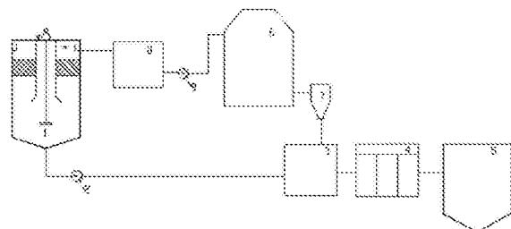
1. 一种超低排放湿式电除尘废水浓缩液处理系统，其特征在于：包括湿电高效澄清器(1)、污泥泵(2)和脱硫废水池(3)，湿电高效澄清器(1)下部的废水浓缩液通过污泥泵(2)连接至脱硫废水池(3)，湿电高效澄清器(1)上部溢流连接至除雾器水箱(8)的进水口，除雾器水箱(8)的出水口通过除雾器水泵(9)连接至脱硫吸收塔(6)的除雾器，脱硫吸收塔(6)的石膏排出泵通过脱硫废水旋流站(7)连接至脱硫废水池(3)，脱硫废水池(3)依次连接脱硫废水三联箱(4)和脱硫废水澄清器(5)。
