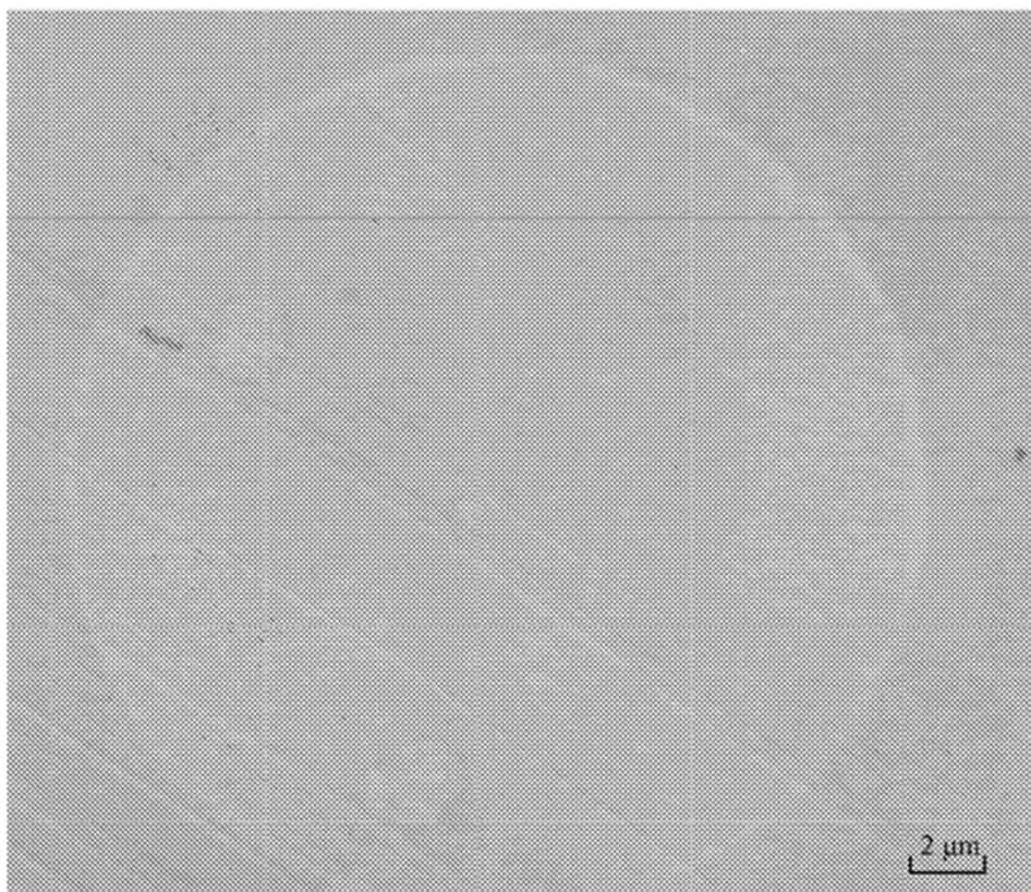
Figura 1 Fotógrafo TEM del Ejemplo Comparativo 1, marcado circular en el fotógrafo es degradación causada por haz de electrones (amplificación x4600)
