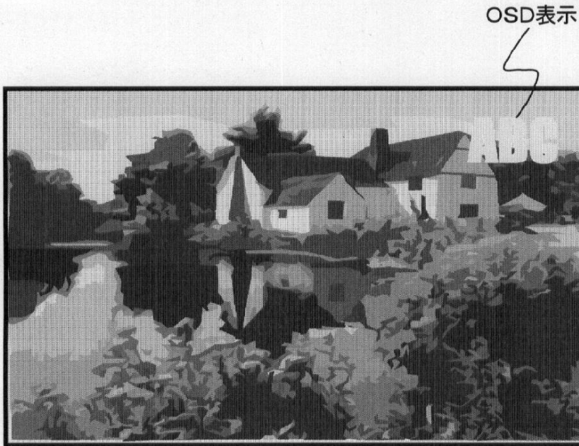
(a) 暗い (APL低) 画像の場合 →バックライト輝度大
